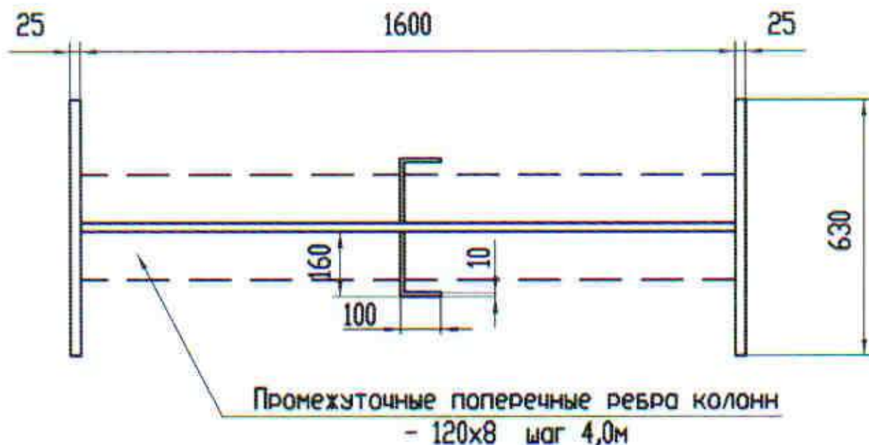
Рисунок 3.5 – Геометрия сечения колонн ряда В на отметках 0 – 27 м (размеры соответствуют проектным).
